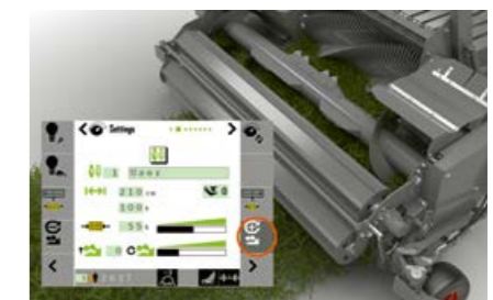
POWER FEEDING SYSTEM går enkelt att reversera från förarhytten.
