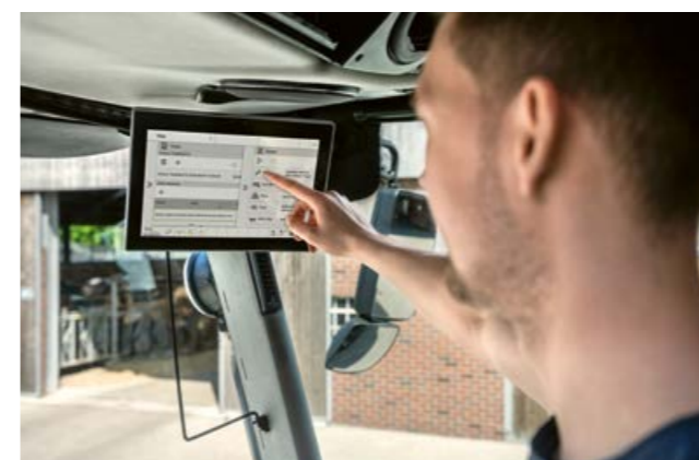
Alla uppdrag kan skapas och hanteras direkt på trösken i CEMIS 1200.
