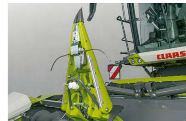
Två sensorbågar känner av två majsradar.
