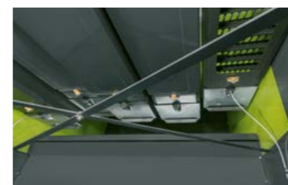
Serviceöppningar baktill på halmskakarna öppnas snabbt och utan verktyg.
