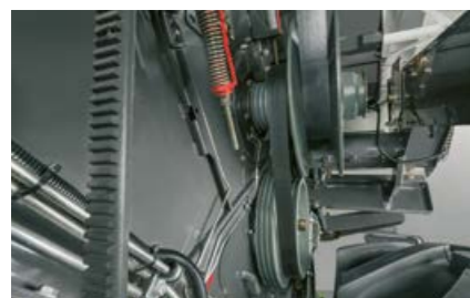
Drivning till tröskcyllindern med två varvtalsområden som enkelt ställs om.
