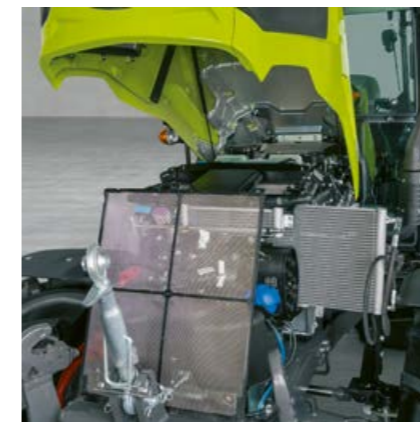
Med ett enkelt handgrepp kan kylaren och kylarkorgen tas ut för kontroll och rengöring.
