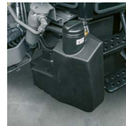
Dieseltanken på 105 liter och ureatanken på 10 liter ger tillräcklig kapacitet även för långa och intensiva arbetsdagar.
