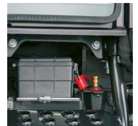
ELIOS 300 förenklar ditt dagliga arbete med många smarta lösningar som t.ex. distribuerade batteripoler till höger i hytten.
