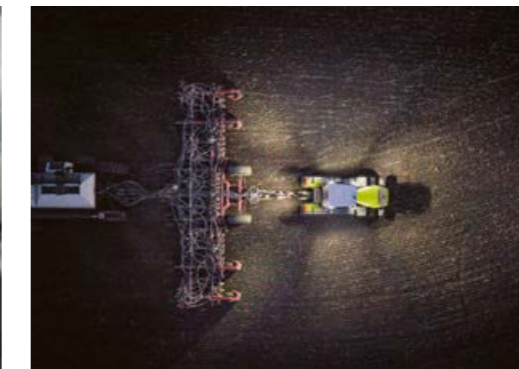
◀ Det avancerade belysningspaketet med upp till 22 LED-strålkastare lyser upp omgivningen 360° med 53400 lm. Alla strålkastare kan riktas för att passa den aktuella uppgiften.
