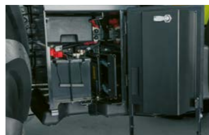
Till höger vid insteget hittar du på lättåtkomlig plats batteriet samt ett förvaringsfack för verktyg.
