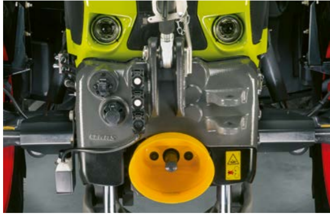
På frontlyften sitter anslutningar för en hydraulventil och en retur.
