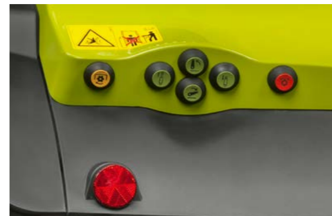
Extern manövrering av bakre kraftuttag
