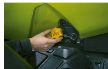
Oljenivåkontroll och påfyllning möjlig även med stängd motorhuv
