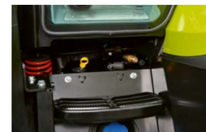
Till vänster i insteget finns ett tryckluftsuttag.
