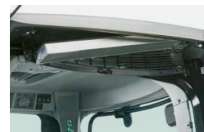
Lätt åtkomst till hyttfilter i hyttaket
