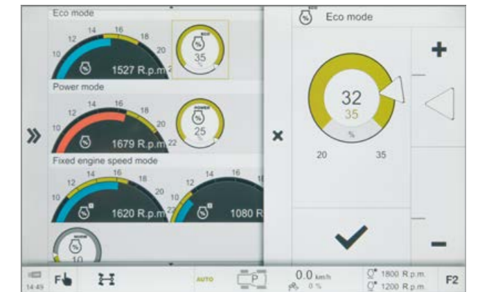
Inställning av motor droop för "Eco" och "Power", samt lagring av motorvarvtalsminne
