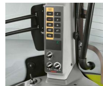
Kraftuttagsvarvtal och elektronisk manövrering av bakre trepunktslyft i B-stolpen.
