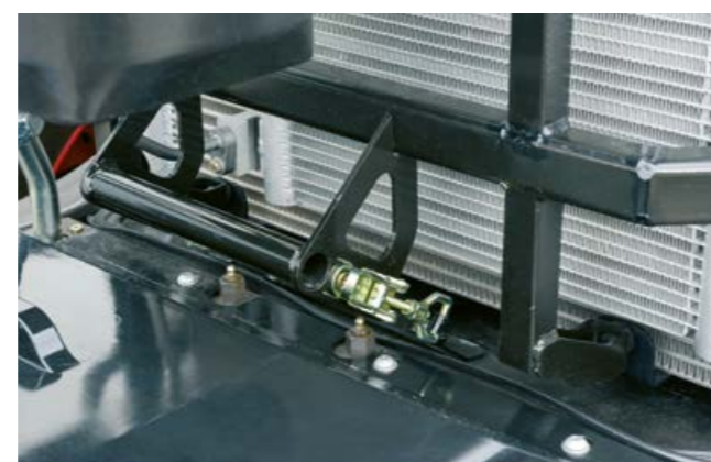
Framaxelns smörjställen placerade framför kylarpaketet för optimal åtkomlighet.
