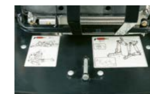
Under motorhuvan finns ett smörjschema som förenklar underhållet.
