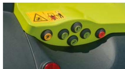
Utvändiga reglage för bakre trepunktslyft, kraftuttag och en valbar hydraulventil (endast CEBIS).
