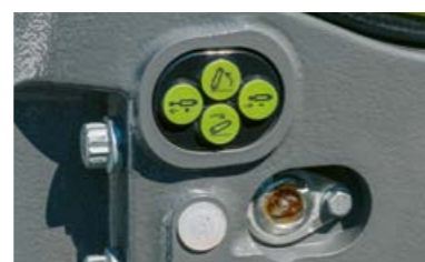
Utvändig manövrering av frontlyft och styrning med CEBIS-utrustning..
