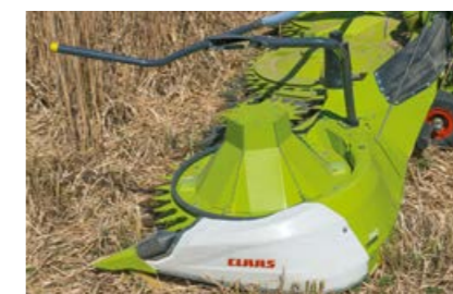
Den stora konen för liggande majs optimerar materialflödet och förhindrar att materialet blir liggande på transportallriken.
