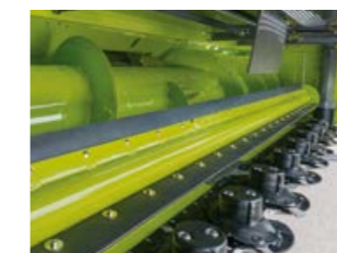
DIRECT DISC 600 P / 500 P har paddelvals med inställbar höjd (hydraulisk som tillval).
