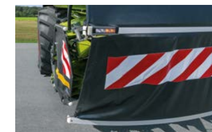
Sido- och frontskydd med väl synliga varningsdekaler. Helt integrerad LED belysning.
