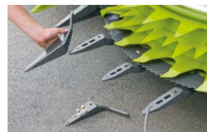
Inmatningsfingrar som kan på- och avmonteras, gör att liggande majs lyfts bättre.
