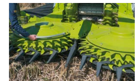
Demontering av kolvfällorna ger bättre flöde.
