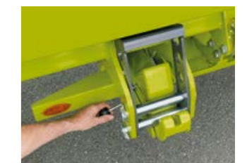
Säker körning efter låsning, i hastigheter upp till 40 km/h.
