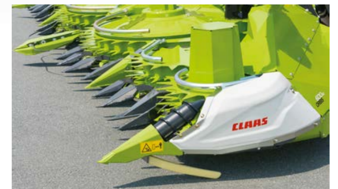
Vid behov, hydraulisk drivning till skruvar för liggande majsgröda.
