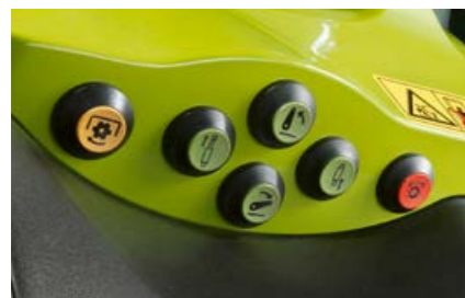
Utvändiga reglage för bakre trepunktslyft, kraftuttag och ett valbart hydrauluttag.
