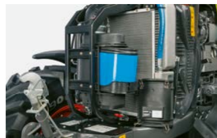
Motorns luftfilter, placerat framför kylarna, når man enkelt från marknivå.
