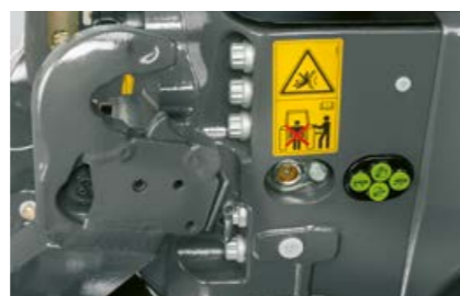
Utvändig manövrering av främre trepunktslyft och ett hydrauluttag.
