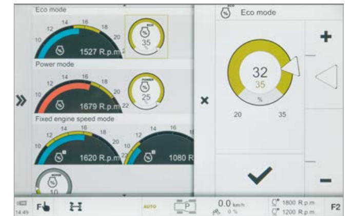
Inställning av motor droop för "Eco" och "Power" samt motorvarvtalsminne.
