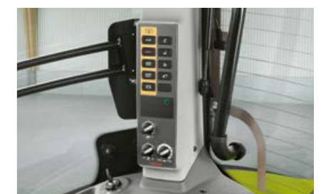
PTO-varvtal och elektronisk reglering av bakre trepunktslyft inställbart från B-stolpen.
