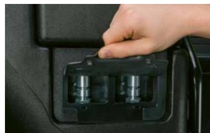
Externa batteripoler nås vid det vänstra insteget.
