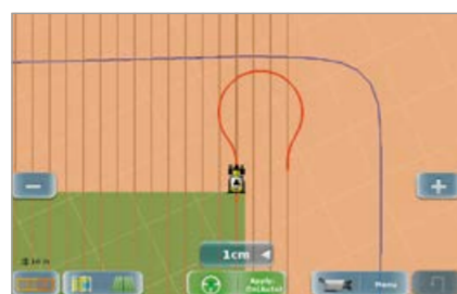
Med AUTO TURN vänder traktorn automatiskt på vändtegen.
